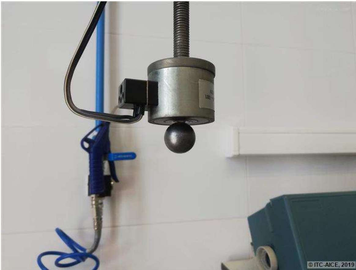
Figura 146. Colocación de la bola de acero en el equipo antes de soltarla para impactar sobre la probeta.
