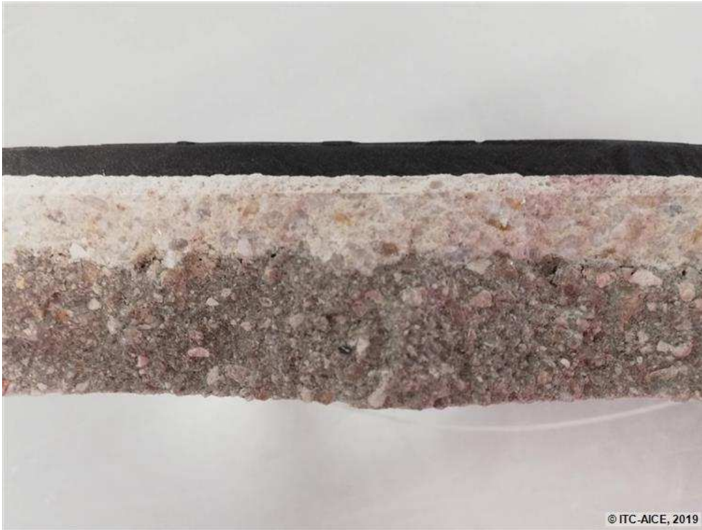
Figura 151. Rotura de la probeta. Todas las capas están adheridas.
