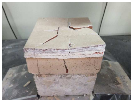
Figura 20. Aspecto de la rotura después del ensayo de resistencia a la carga puntual.
