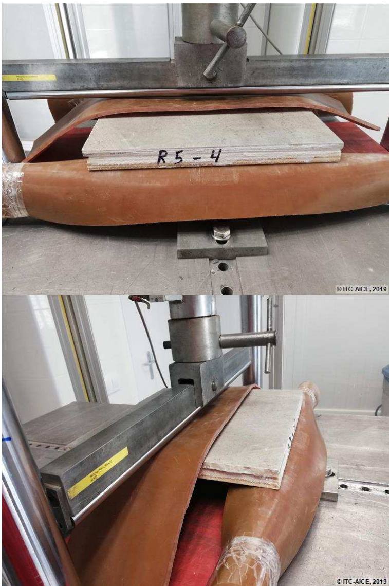
Figura 156. Montaje del ensayo de flexión: Probeta R5-4
