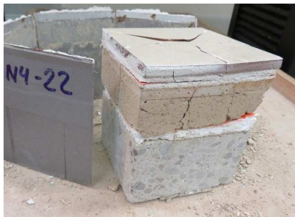
Figura 18. Aspecto de la rotura después del ensayo de resistencia a la carga puntual.
