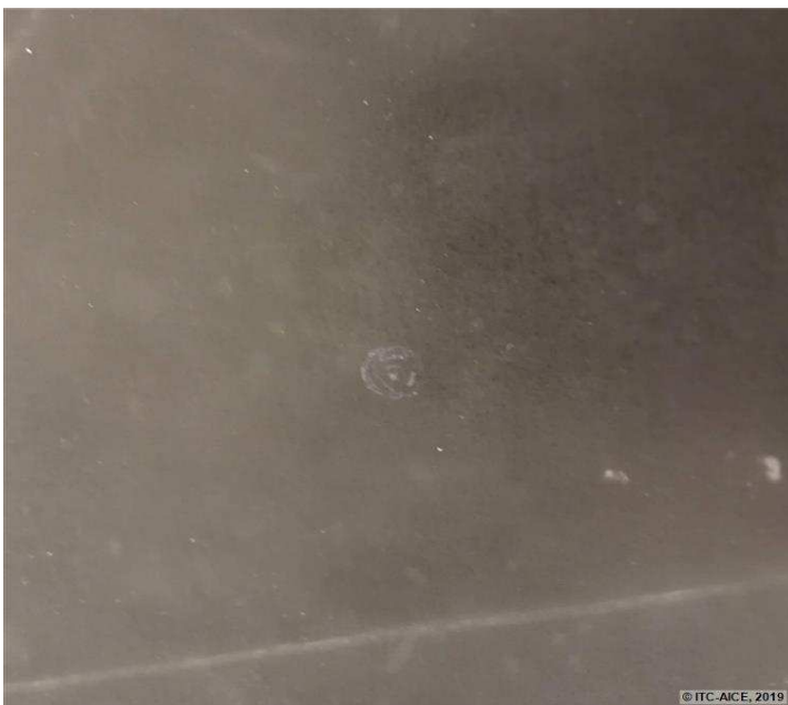
Figura 119. Detalle de la fisura circular de la probeta ON1-12
