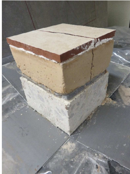
Figura 50. Aspecto de la rotura después del ensayo de resistencia a la carga puntual.
