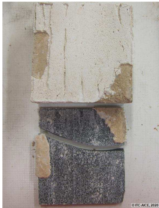
Figura 170. Aspecto de la rotura después del ensayo de resistencia a la cizalla
