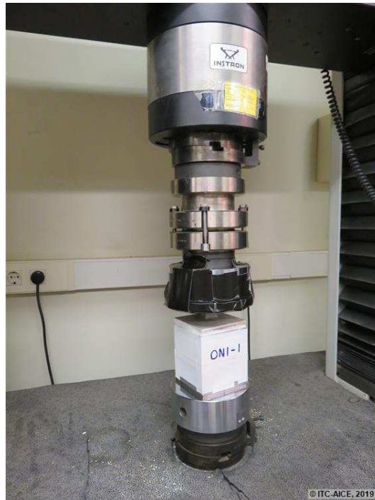
Figura 2. Detalle del ensayo de determinación de la resistencia mecánica a la carga puntual.
