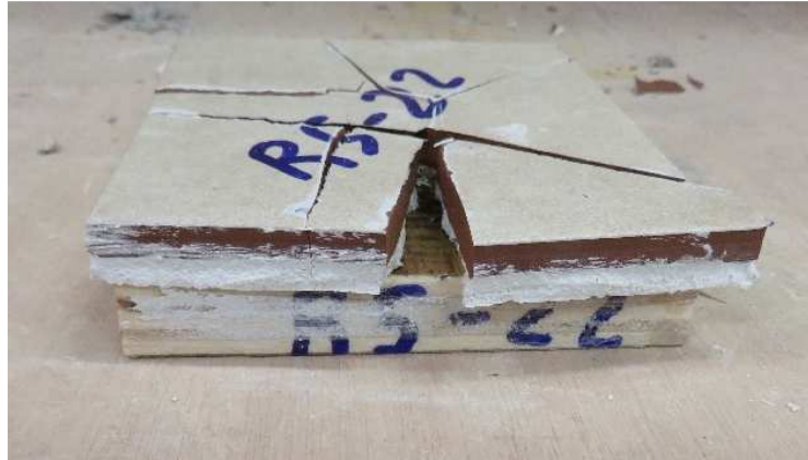
Figura 36. Aspecto de la rotura después del ensayo de resistencia a la carga puntual.
