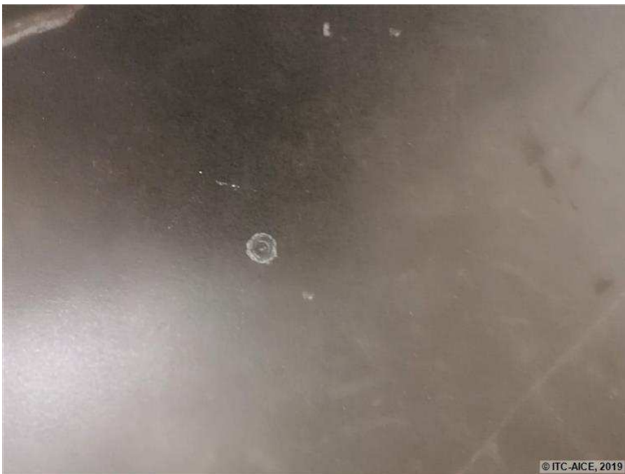
Figura 140. Detalle de las fisuras circulares de la probeta R1-15
