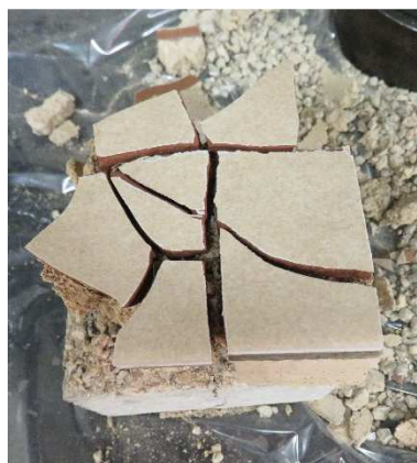
Figura 92. Aspecto de la rotura después del ensayo de resistencia a la compresión.
