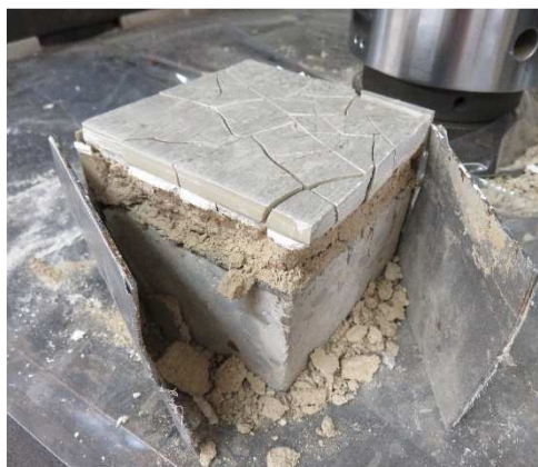
Figura 94. Aspecto de la rotura después del ensayo de resistencia a la compresión.
