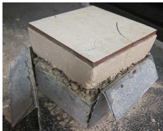
Figura 90. Aspecto de la rotura después del ensayo de resistencia a la compresión.
