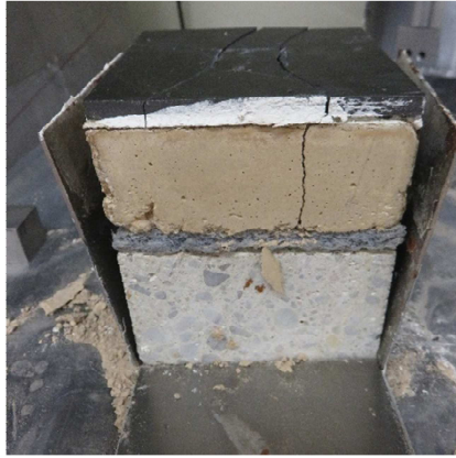
Figura 52. Aspecto de la rotura después del ensayo de resistencia a la carga puntual.
