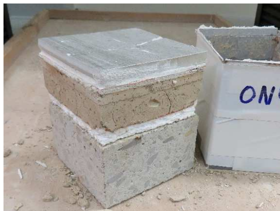
Figura 16. Aspecto de la rotura después del ensayo de resistencia a la carga puntual.
