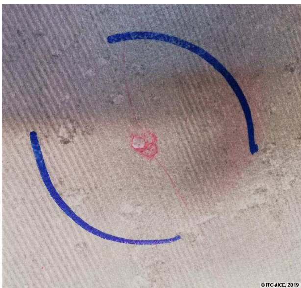
Figura 121. Detalle de la fisura radial de la probeta ON1-68
