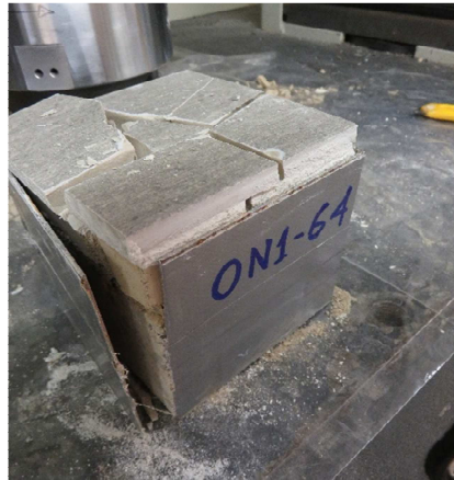
Figura 56. Aspecto de la rotura después del ensayo de resistencia a la carga puntual.
