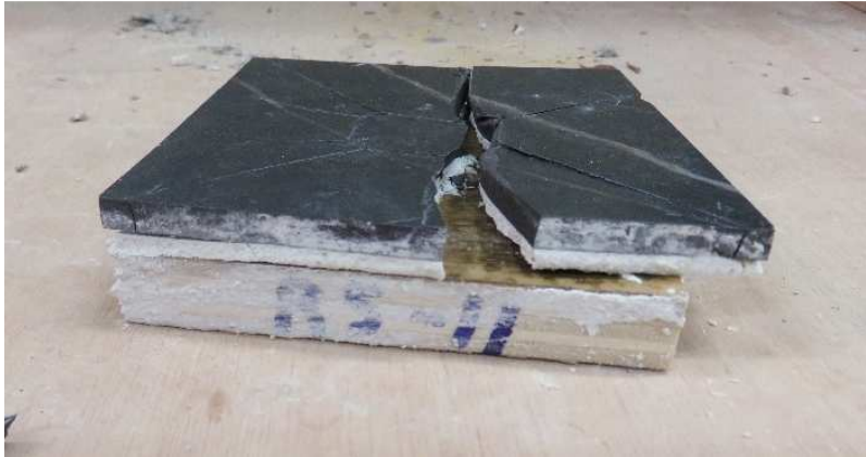
Figura 38. Aspecto de la rotura después del ensayo de resistencia a la carga puntual.
