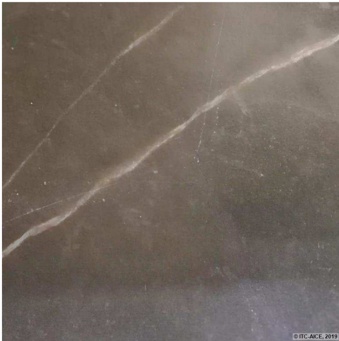
Figura 144. Detalle de las fisuras radiales de la probeta R5-15
