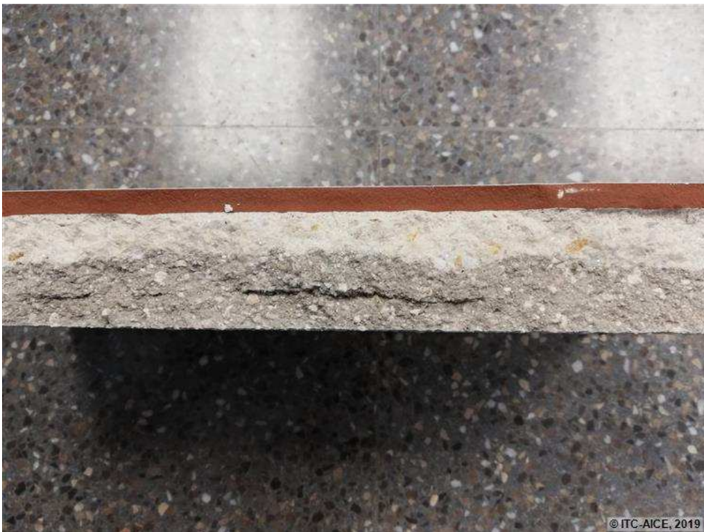
Figura 154. Rotura de la probeta R1-27. La capa inferior (terrazo) presenta fisuras transversales.
