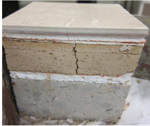
Figura 42. Aspecto de la rotura después del ensayo de resistencia a la carga puntual.
