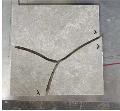
Figura 60. Aspecto de la rotura después del ensayo de resistencia a la carga puntual.
