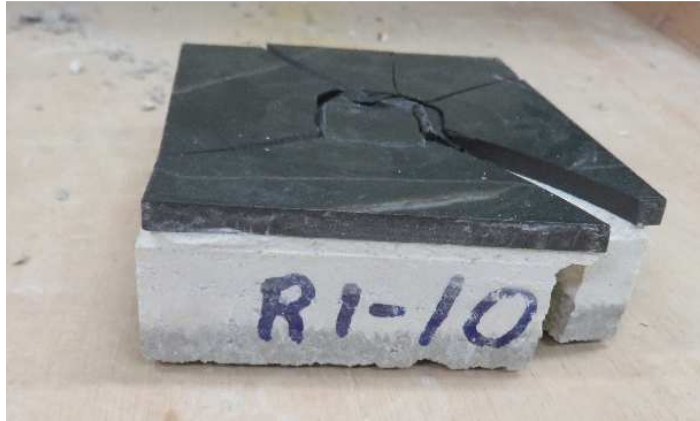
Figura 32. Aspecto de la rotura después del ensayo de resistencia a la carga puntual.
