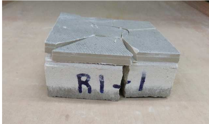
Figura 28. Aspecto de la rotura después del ensayo de resistencia a la carga puntual.
