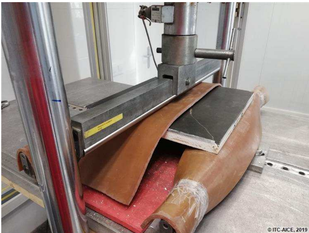
Figura 159. Montaje del ensayo de flexión: Probeta R5-4
