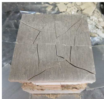
Figura 96. Aspecto de la rotura después del ensayo de resistencia a la compresión.
