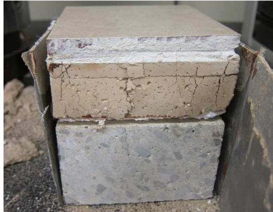
Figura 88. Aspecto de la rotura después del ensayo de resistencia a la compresión.
