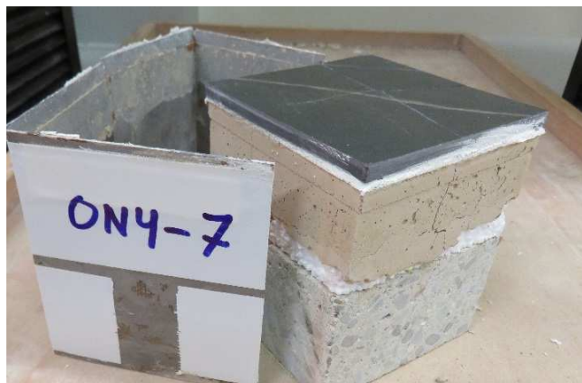
Figura 22. Aspecto de la rotura después del ensayo de resistencia a la carga puntual.
