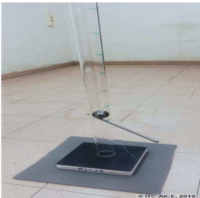
Figura 114. Montaje del ensayo. La bola de acero se encuentra dentro del cilindro, el cual está dividido en las alturas de ensayo, desde 300 mm hasta 1000 mm en subdivisiones de 100 mm.
