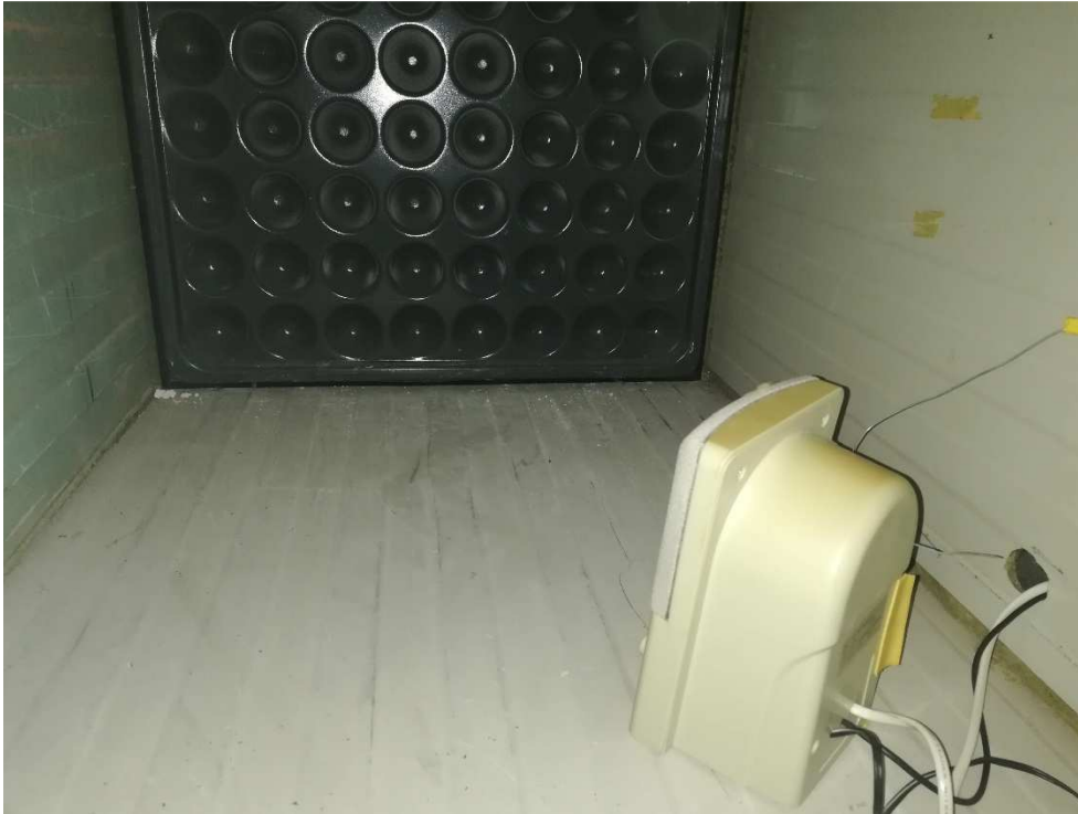
Figura 174 Detalle del sistema de posicionamiento del altavoz en la cabina de emisión.
