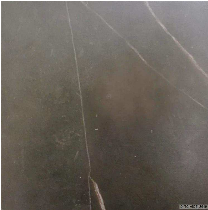
Figura 118. Defectos aparecidos en la probeta ON1-12. Se puede observar la fisura circular en la zona de impacto.
