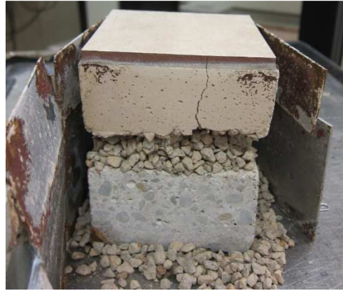
Figura 46. Aspecto de la rotura después del ensayo de resistencia a la carga puntual.
