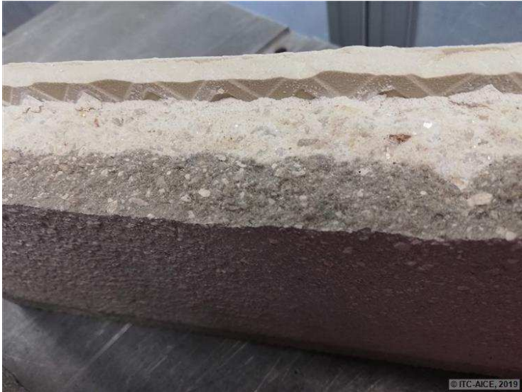
Figura 149. Rotura de la probeta. Todas las capas están adheridas.
