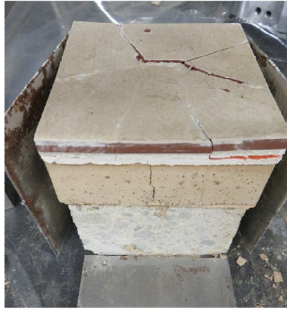
Figura 44. Aspecto de la rotura después del ensayo de resistencia a la carga puntual.
