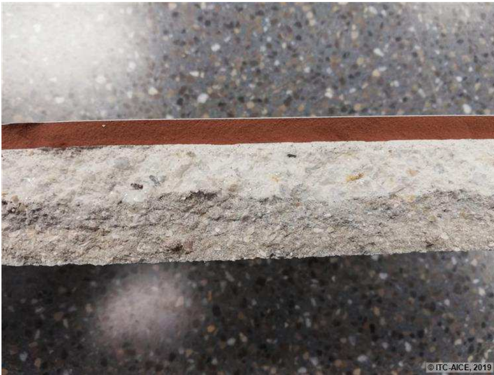
Figura 153. Rotura de la probeta. Todas las capas están adheridas.
