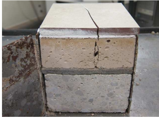
Figura 40. Aspecto de la rotura después del ensayo de resistencia a la carga puntual.
