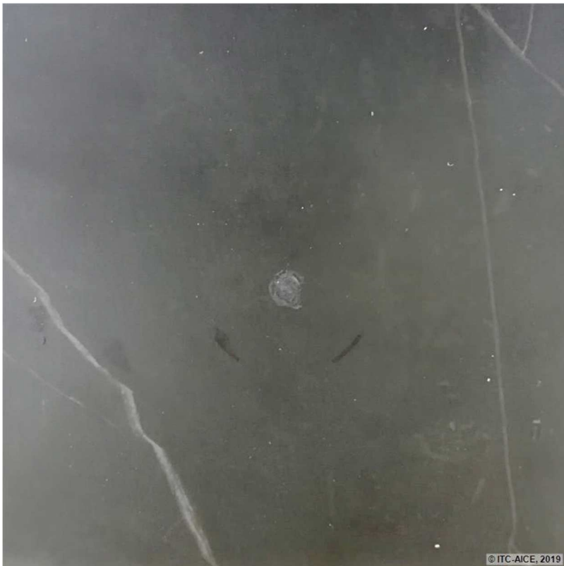
Figura 137. Defectos aparecidos en la probeta R1 - 14. Se puede observar el desconchado que aparecen en la zona de impacto.
