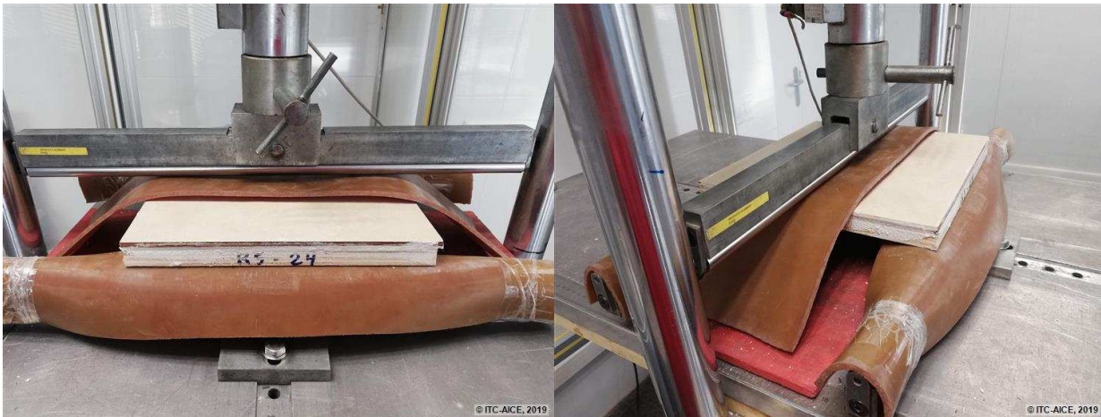
Figura 162. Montaje del ensayo de flexión: Probeta R5-4
