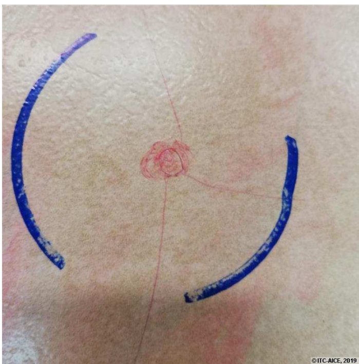
Figura 124. Detalle de la fisura radial de la probeta ON1-70
