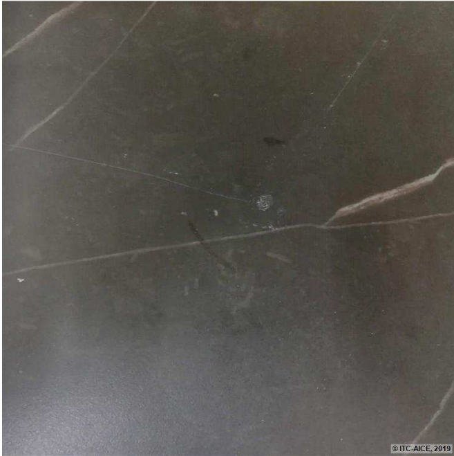
Figura 129. Defectos aparecidos en la probeta ON4-11. Se puede observar las fisuras radiales que atraviesan la pieza desde el centro hasta el extremo de la probeta
