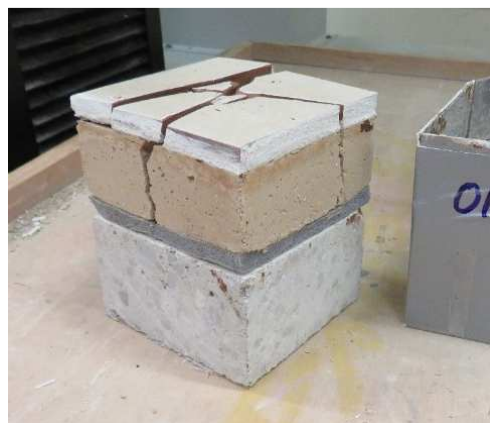
Figura 12. Aspecto de la rotura después del ensayo de resistencia a la carga puntual.
