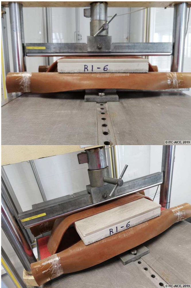
Figura 148 Montaje del ensayo de flexión: Probeta R1-6
