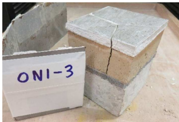
Figura 10. Aspecto de la rotura después del ensayo de resistencia a la carga puntual
