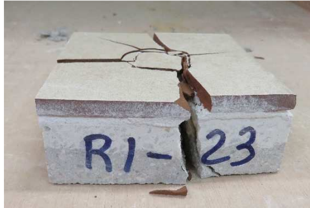
Figura 30. Aspecto de la rotura después del ensayo de resistencia a la carga puntual.
