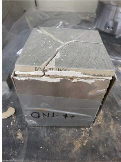
Figura 48. Aspecto de la rotura después del ensayo de resistencia a la carga puntual
