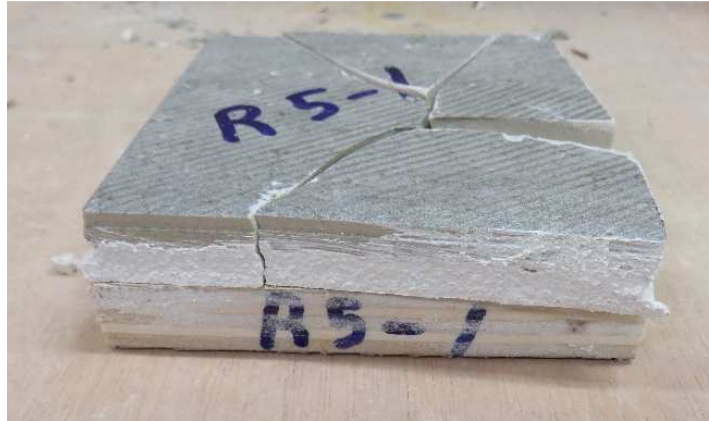
Figura 34. Aspecto de la rotura después del ensayo de resistencia a la carga puntual.
