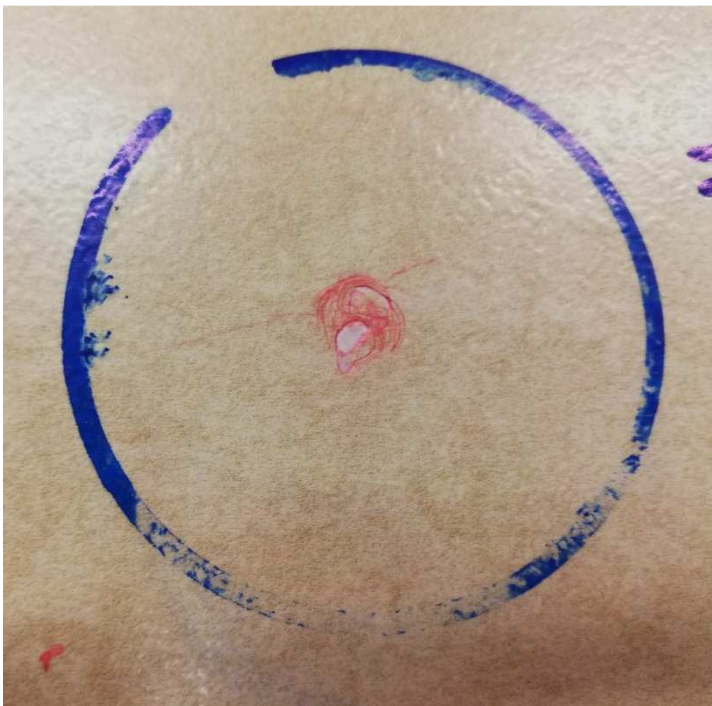
Figura 127. Detalle de la fisura radial de la probeta ON1-97
