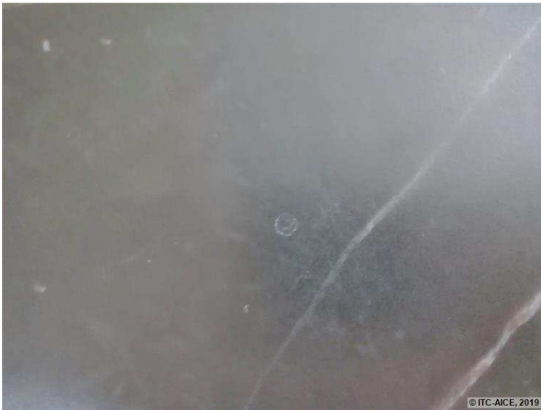
Figura 132. Detalle de la fisura circular de la probeta ON4-12
