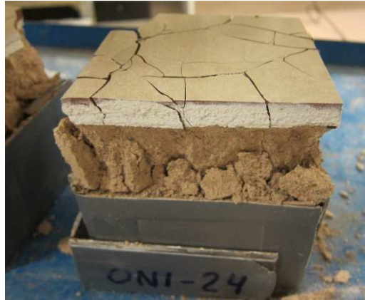
Figura 86. Aspecto de la rotura después del ensayo de resistencia a la compresión.
