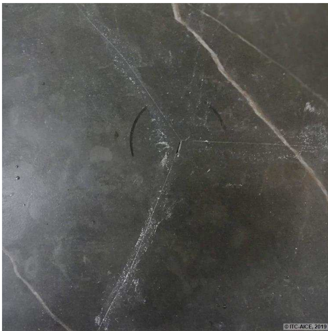
Figura 141. Defectos aparecidos en la probeta R5 - 14. Se puede observar el desconchado que aparece en la zona de impacto y las fisuras radiales.
