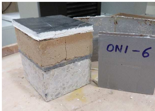
Figura 14. Aspecto de la rotura después del ensayo de resistencia a la carga puntual.
