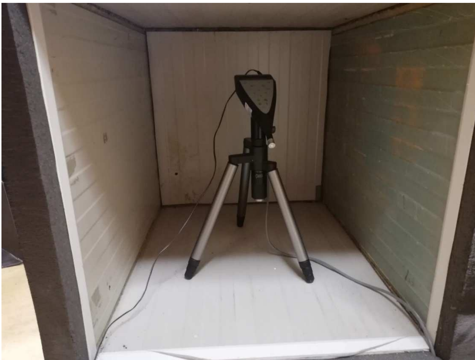
Figura 173 Detalle del sistema de posicionamiento del sonómetro en la cabina de recepción.
