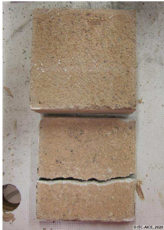
Figura 168. Aspecto de la rotura después del ensayo de resistencia a la cizalla
