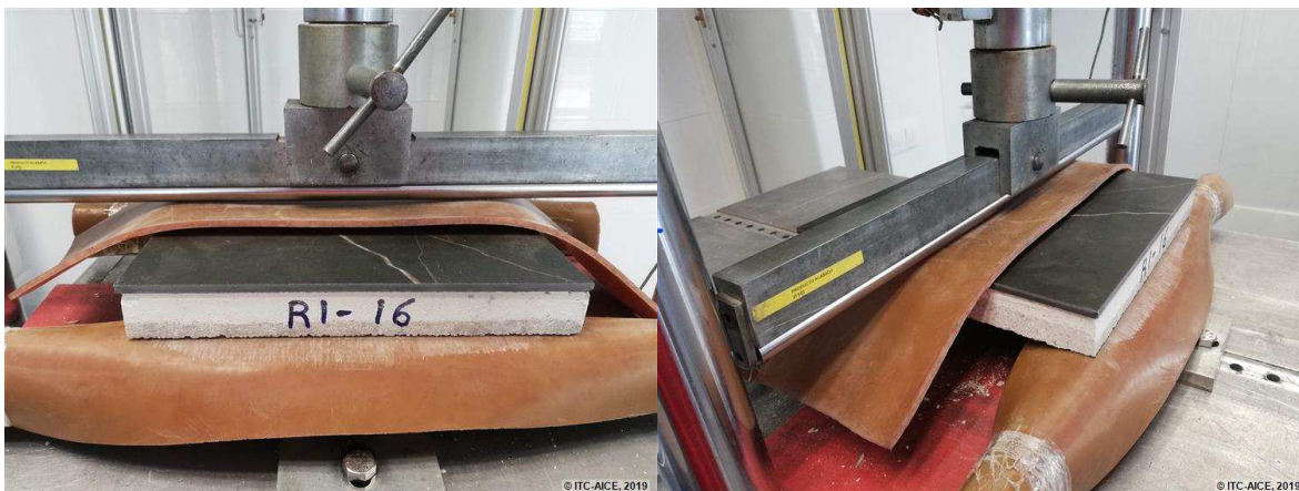
Figura 150. Montaje del ensayo de flexión: Probeta R1-16
