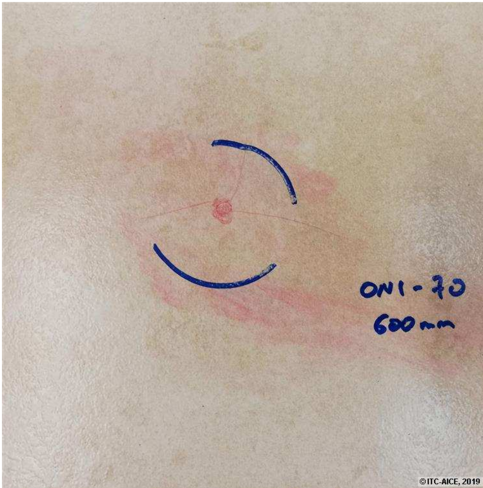
Figura 123. Defectos aparecidos en la probeta ON1-70. Se puede observar la fisura radial que se genera en la pieza desde el centro.
