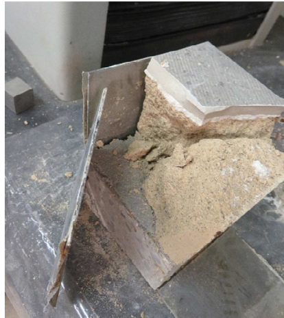
Figura 58. Aspecto de la rotura después del ensayo de resistencia a la carga puntual.
