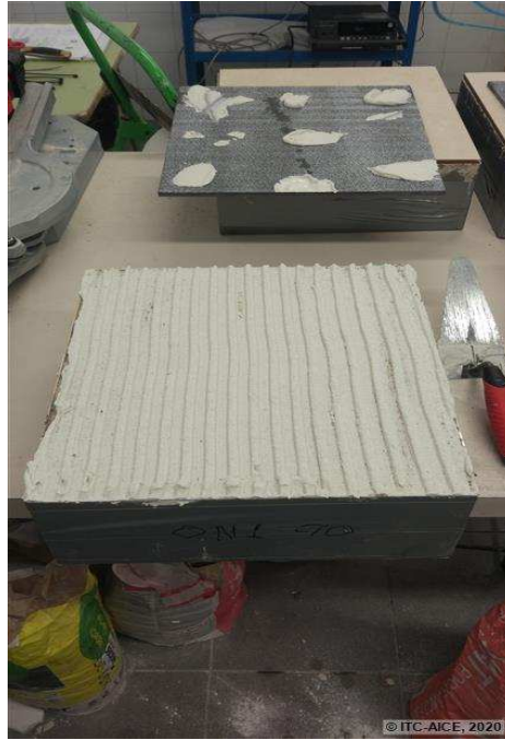
Figura 107. Aplicación del adhesivo
