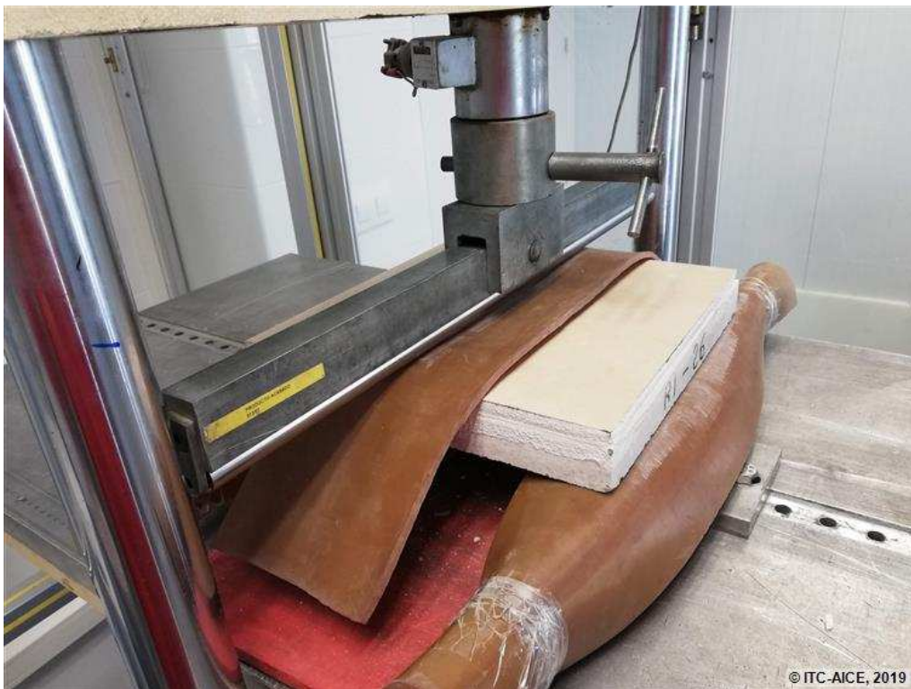
Figura 152. Montaje del ensayo de flexión: Probeta R1-26
