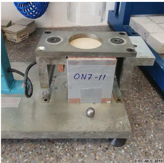
Figura 145. colocación de la probeta de ensayo en el equipo de impacto por medida del coeficiente de restitución.
